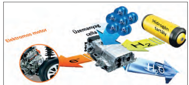
2. ábra. A hidrogéncellás hajtás sematikus ábrázolása
