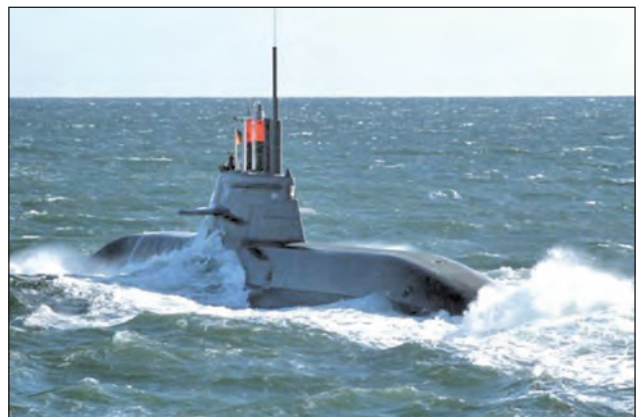
9. ábra. Az U 31-es a német haditengerészet legújabb, U 212 osztályú tengeralattjárója, amelyet üzemanyagcellás AIP-rendszerrel láttak el
