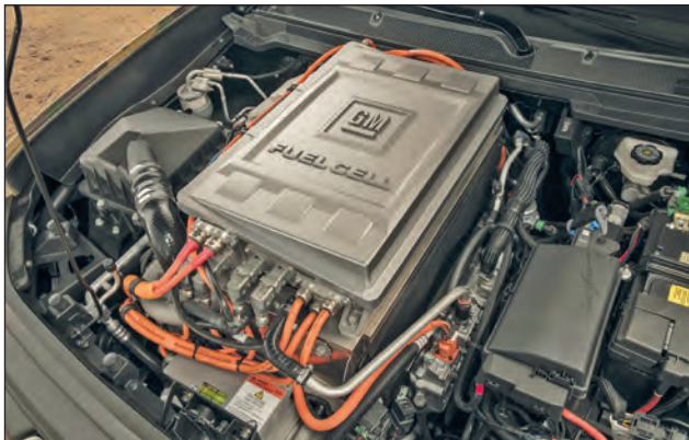
10. ábra. A Fort Carsonban tesztelt Chevrolet Colorado ZH2 terepjáró „erőműve”
