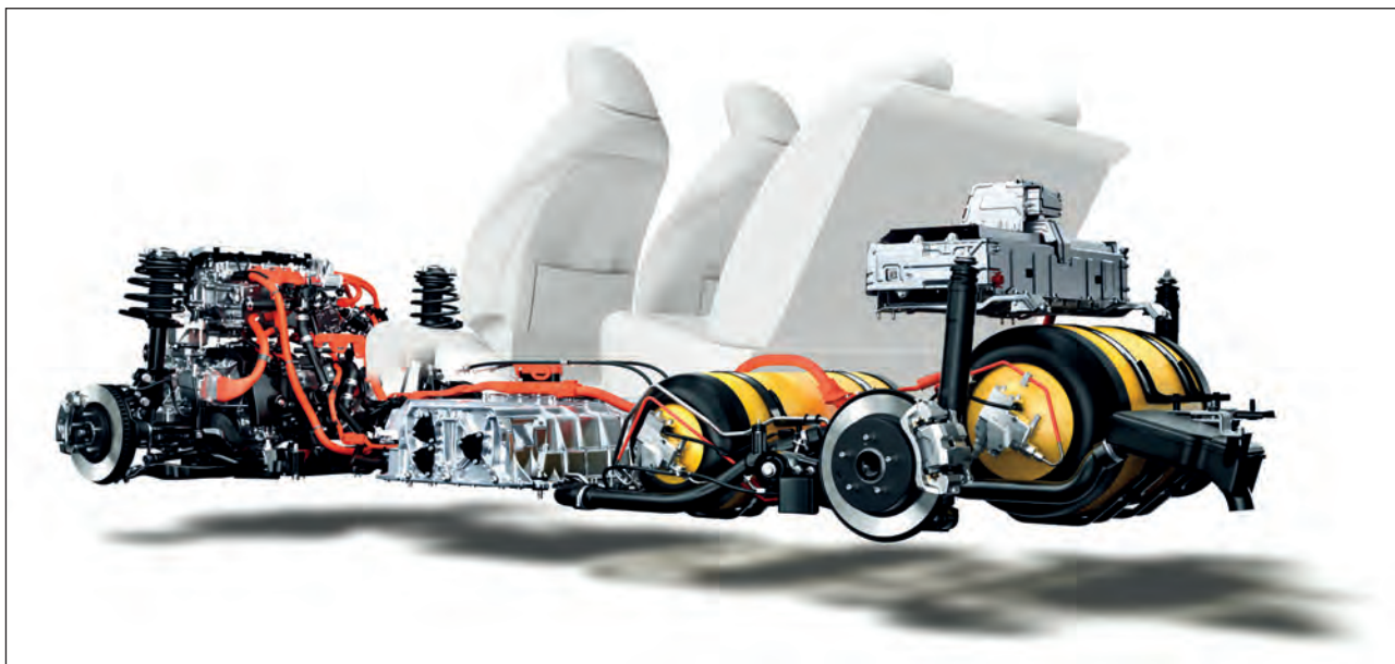
4. ábra. A Toyota Mirai hidrogéncellás szedán meghajtórendszerének ábrája
